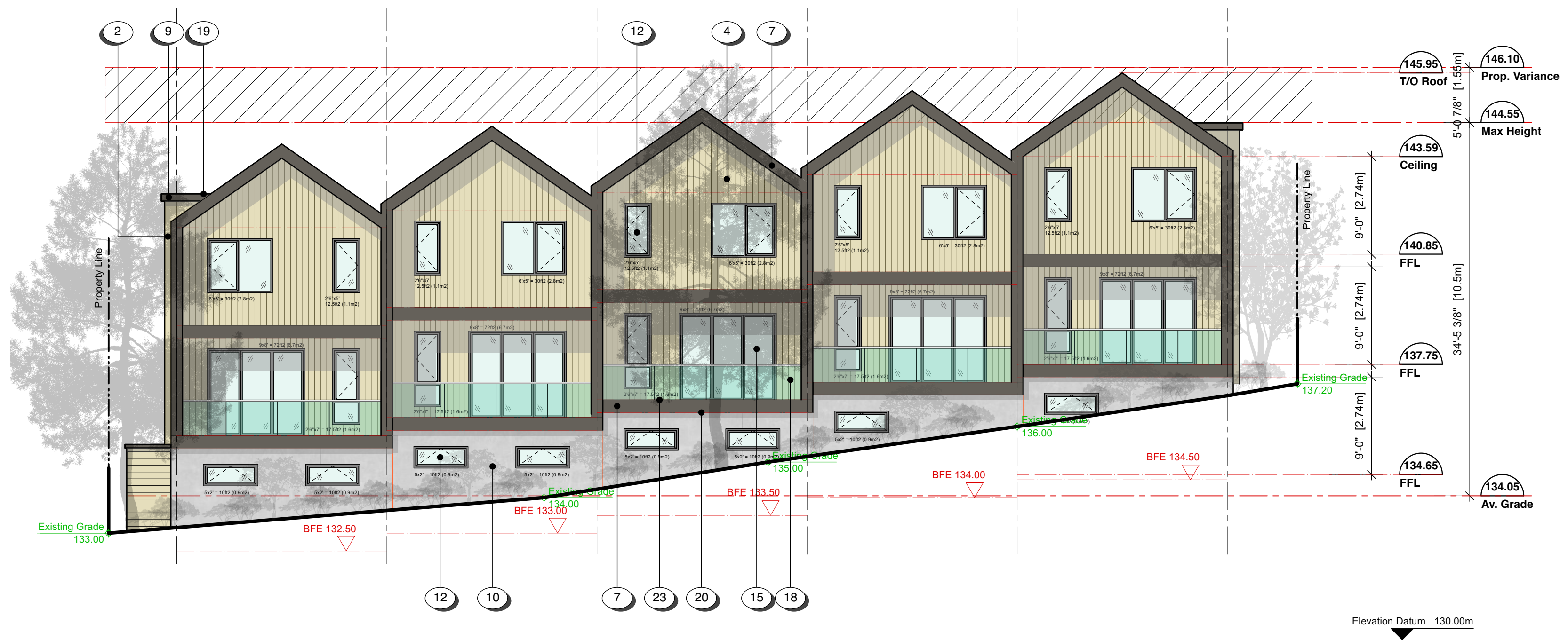
4 NW Elevation (Building 4) Scale: 1:100
